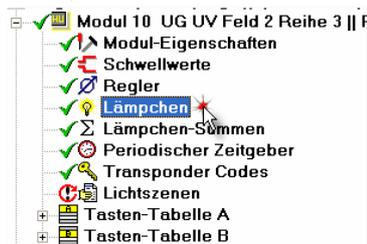
Es müssen nun alle 8 Lämpchen im Modul 10 so programmiert werden, dass sie den Zustand der 8 Binäreingänge vom Modul 10 anzeigen.
