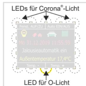
Das LCN-GT4D (LCN-GTS4D) besitzt eine eingebaute 24-Kanal **Zeitschaltuhr** mit 96 Schaltzeitpunkten. Die 24 Kanäle können per LCN-PRO frei beschriftet werden, so dass eine einfache Änderung der Schaltzeitpunkte vom Nutzer vorgenommen werden kann. Aufgerufen wird das Nutzermenue über das gleichzeitige Betätigen der Tasten D2+D3 - siehe auch Online-Hilfe der LCN-PRO.
