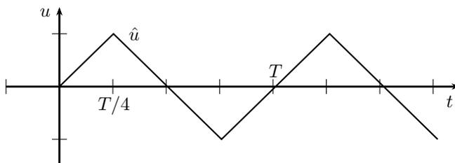
Figure 3: Dreiecksspannung
