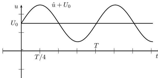
Figure 5: Sinusspannung mit Offset
