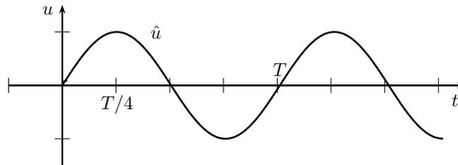
Figure 2: Sinusspannung
