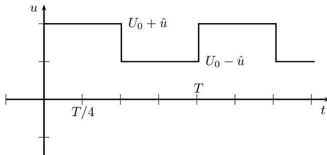
Figure 4: Rechteckspannung mit Offset
